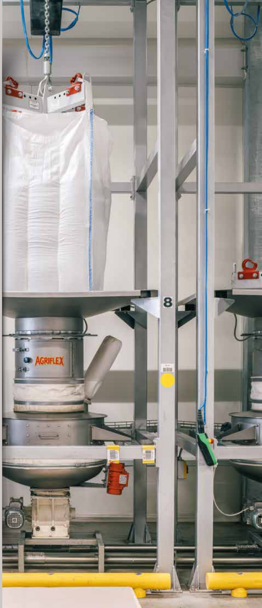
في الأسفل، محطة لتفريغ الأكياس الكبيرة (BIG-BAG). BIG BAG UNLOADING SYSTEM.
