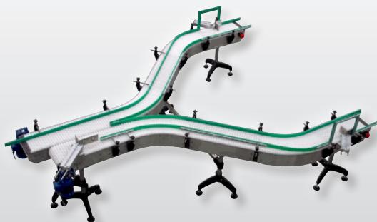
struttura in FE 360
