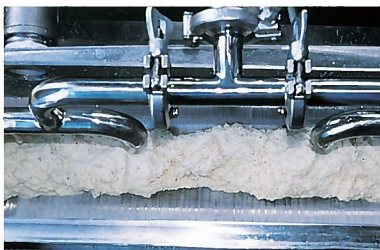
◆ローラーフィルター部による搾り(一次搾り) Pressing by roller filters (primary pressing)
