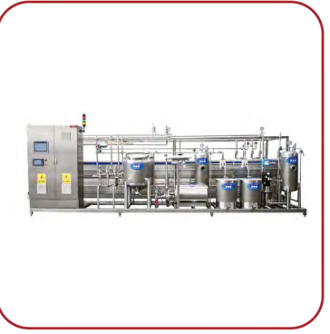
列管式杀菌机 Tubular sterilizer
