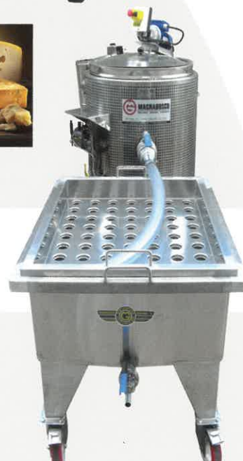
Cow batch a gas da lt. 300 con scarico frontale, vasca raccolta cagliata con stampiera e agitatore fisso. Gas Cow batch capacity 300 lts. Equipped with front curd outlet, mould curd vat and mixer.
