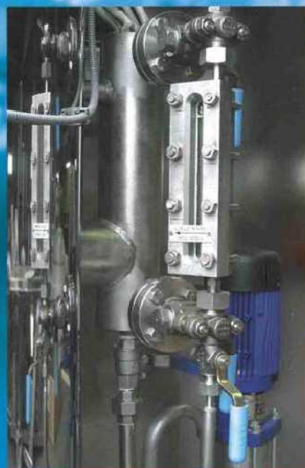
GRUPPO INDICATORE DI LIVELLO COMPLETO DI RUBINETTI DI SPURGO E GRUPPO DI CONTROLLO LIVELLO COMPLETO DI 4 SONDE LEVEL UNIT WITH DRAIN VALVES AND CONTROL LEVEL UNIT WITH N. 4 PROBES
